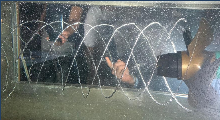
tip vortex cavitation
